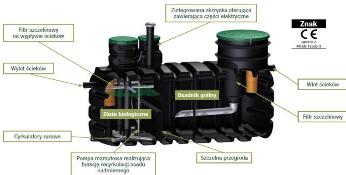
Rysunek 15. Schemat oczyszczalni hybrydowej typu BIO UNO
